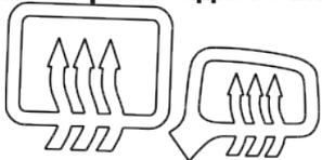
Активируется нажатием соответствующего выключателя (показан на рисунке) при включенном зажигании.
