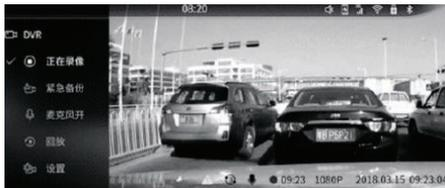
Автомобиль оснащен встроенным видеорегистратором. По умолчанию он автоматически включает записи во время движения. По достижении лимита доступной памяти новые видеоролики записываются поверх старых. При необходимости видеозаписи можно импортировать на другие носители.
