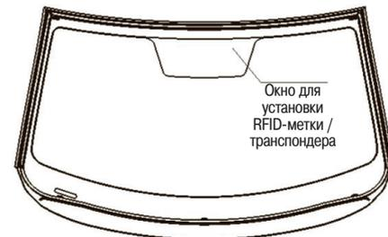
Если автомобиль оснащается зеркалом заднего вида с видеорегистратором, для установки RFID-метка/транспондера необходимо сначала снять декоративную накладку. См. рис. ниже.
